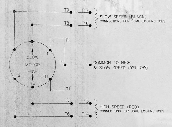
1 - 11 MOTOR COMMON MARKINGS (YELLOW) 2 - 3 MOTOR SLOW SPEED MARKINGS (BLACK) 12 - 13 MOTOR HIGH SPEED MARKINGS (RED)
